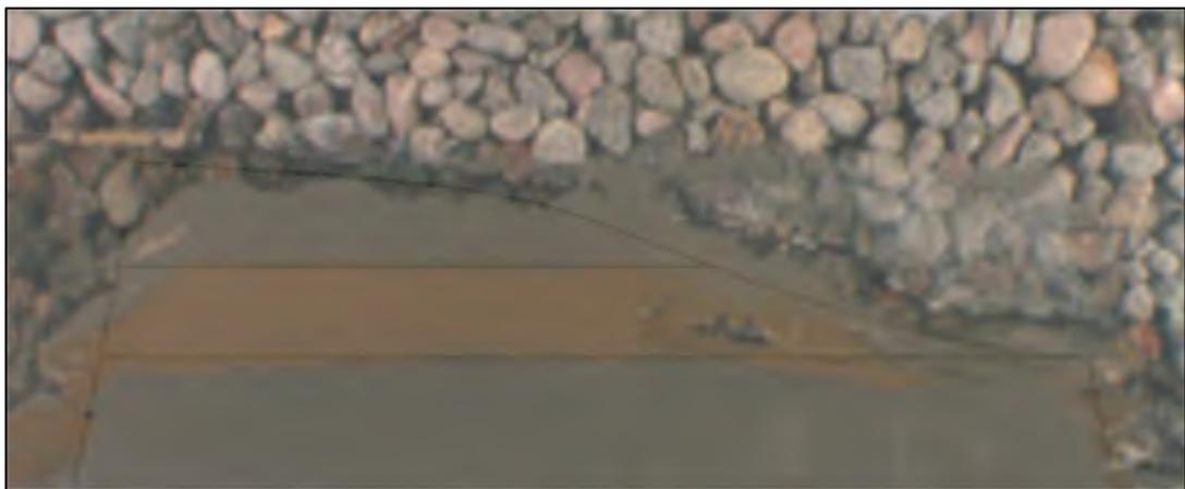
Figure 4.2 Géométrie finale du noyau - Essai n° 2
