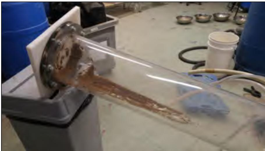
Figure 2.16 Nettoyage d'une colonne de sédimentation
