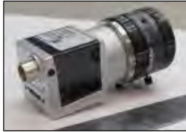
Figure 2.5 Caméra numérique Basler ACA2500 avec lentille Computar M0825-MP
