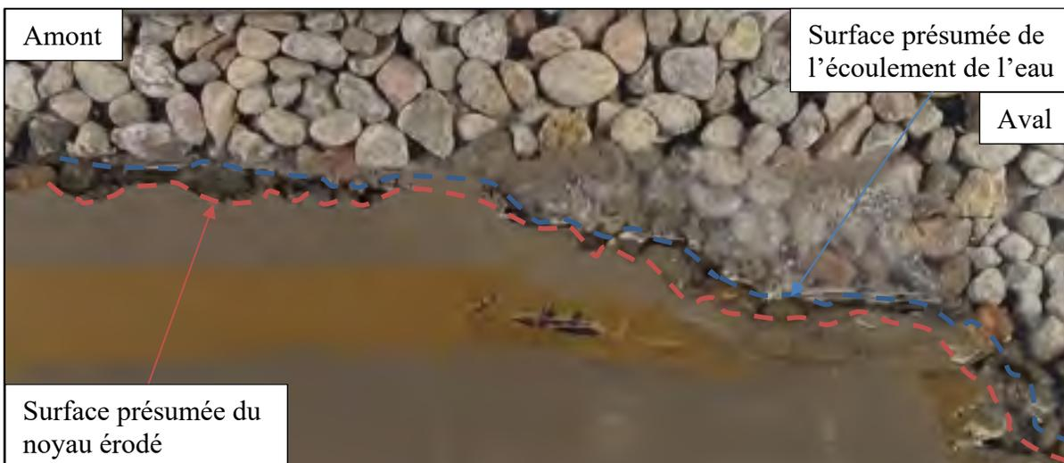
Figure 3.8 Forme finale du noyau érodé, avant du montage essai n° 2
