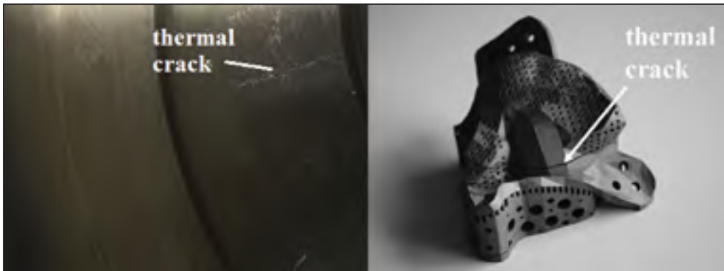
Figure 1.9 Fissuration observée lors de la fabrication de composants par LPBF Tirée et adaptée de (Kruth et al., 2012)
