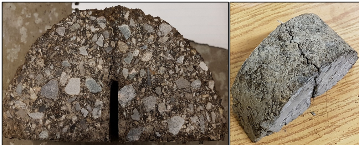
Figure 4.6 Rupture des éprouvettes de l'essai SCB
