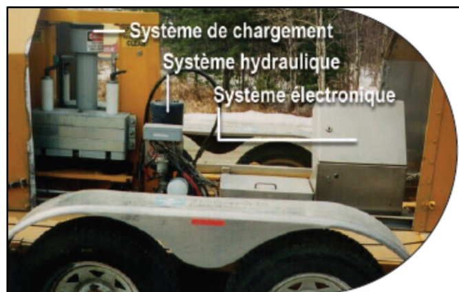
Figure 7.1 Les systèmes de FWD (MTQ, 2013)
