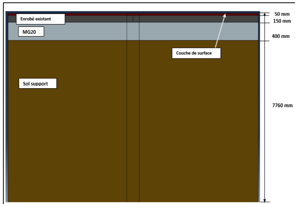
Figure 8.5 Structure réhabilitée par un planage-resurfaçage
