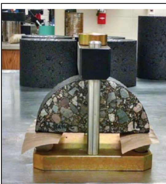
Figure 1.13 Essai de flexion semi-circulaire (ASTM, 2016)
