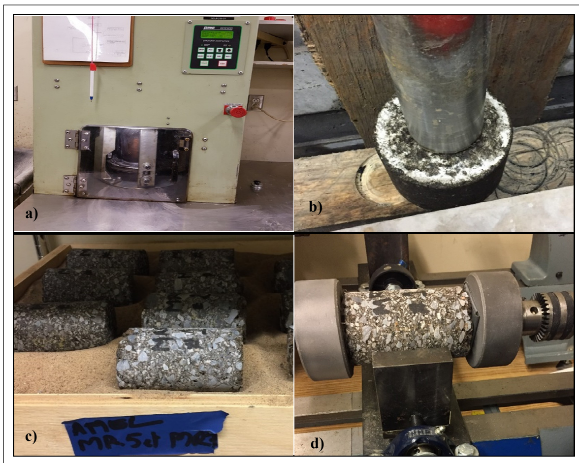
Figure 3.4 Préparation des éprouvettes pour l'essai de module complexe (a) Compactage à la PCG (b) Carottage des éprouvettes (c) Entreposage des éprouvettes (d) Collage des casques
