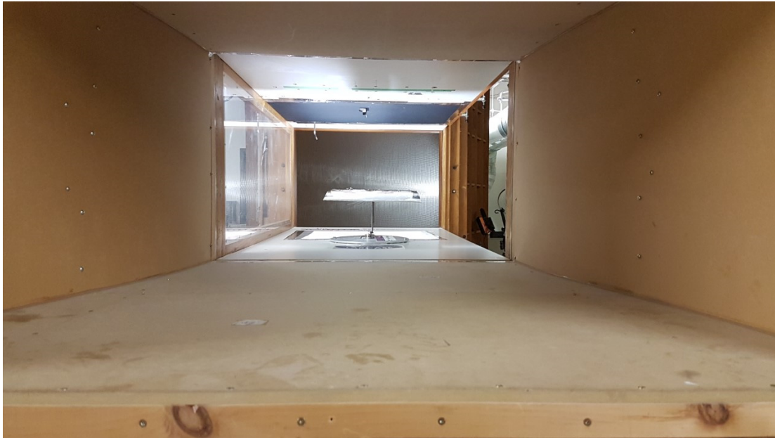
Figure 6-6 : Maquette et fixation dans la chambre d'essai de la soufflerie
