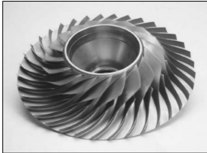
Figure 1.2 Roue à aubes de petit moteur aéronautique en Ti-6242 Tirée de Lütjering & Williams (2007)
