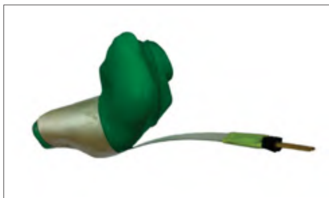
Figure 1.12 Microrécupérateur d'énergie intra-auriculaire utilisant le mode de transduction piézoélectrique, tirée de Delnavaz & Voix (2013b)
