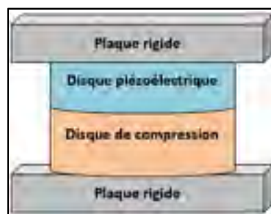
Figure 2.4 Géométrie du générateur proposé
