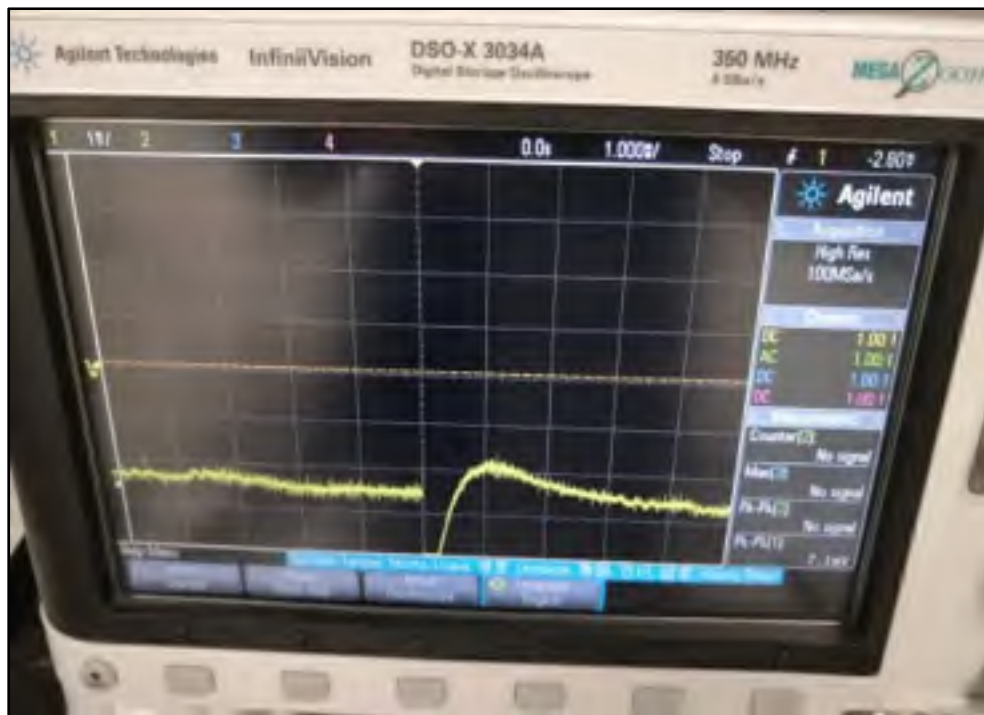
Figure 5.12 Tension mesurée pour 2W de puissance injectée
