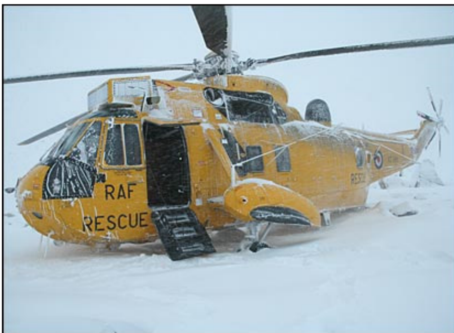
Figure 0.2 Hélicoptère contaminé par le givre et en attente de secours Tirée de BBC (2006)
