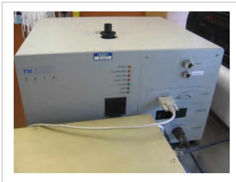
Figure 2.4: Le spectrophotomètre aérodynamique à fluorescence UV-APS 3314
