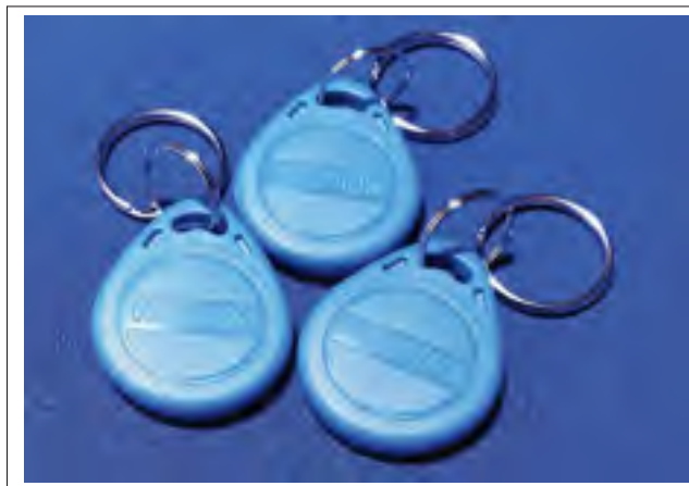
Figure 3.25 Les tags RFID utilisés pour l'expérimentation
