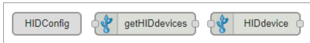
Figure 4.5 Noeuds de Node-Red pour la gestion des connexions via le port USB
