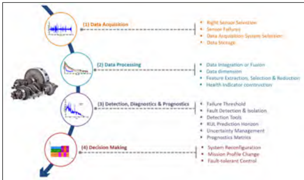
Figure 1.16 Étapes du processus de pronostic et leurs principaux challenges (Atamuradov et al., 2017a)
