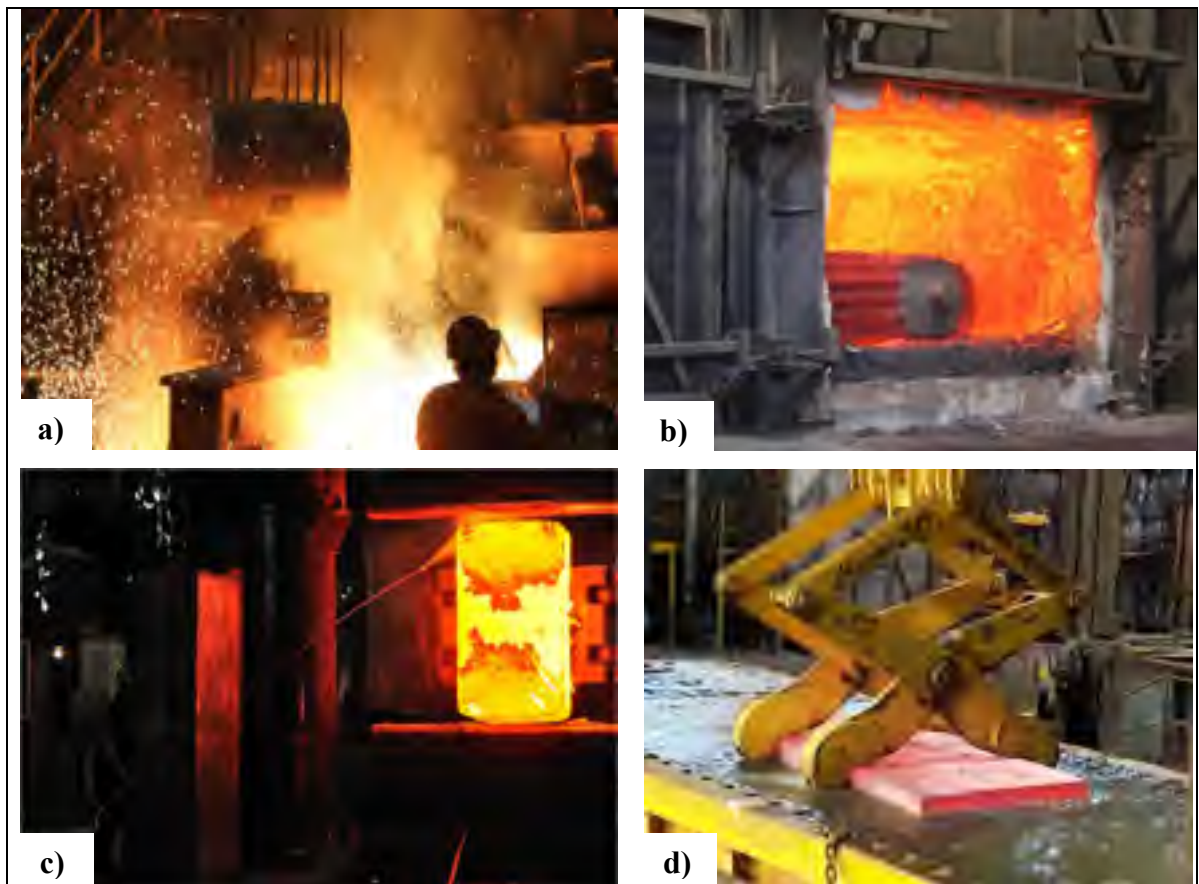
Figure 0-1. Étapes de fabrication d'une brame d'acier chez Finkl Steel -Sorel : a) Coulée en lingotière b) Chauffage au four de forgeage c) Forgeage à chaud d) Trempe à l'eau.
