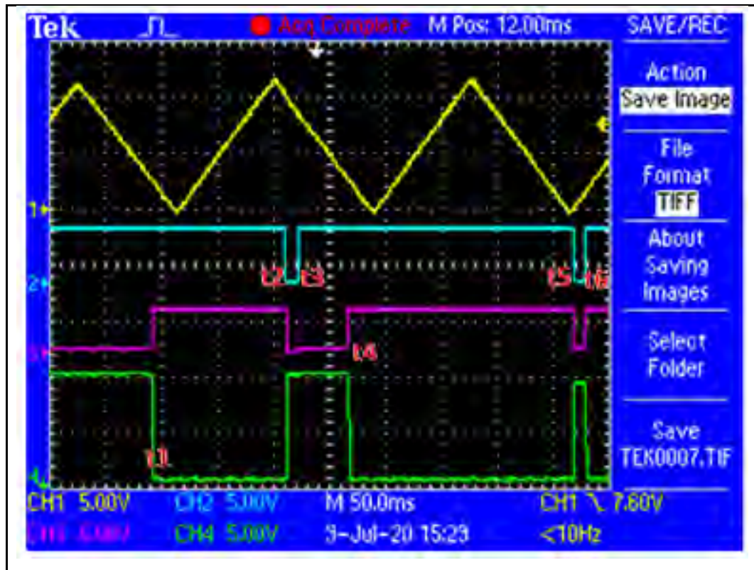
Figure 4.2 Validation pratique du circuit de déconnexion. Les signaux du haut vers le bas représentent respectivement le signal d’émulation de V_{pv} , le signal de réactivation interne, le signal de sortie de l’optoisolateur et le signal de sortie du driver photovoltaïque (DPV)
