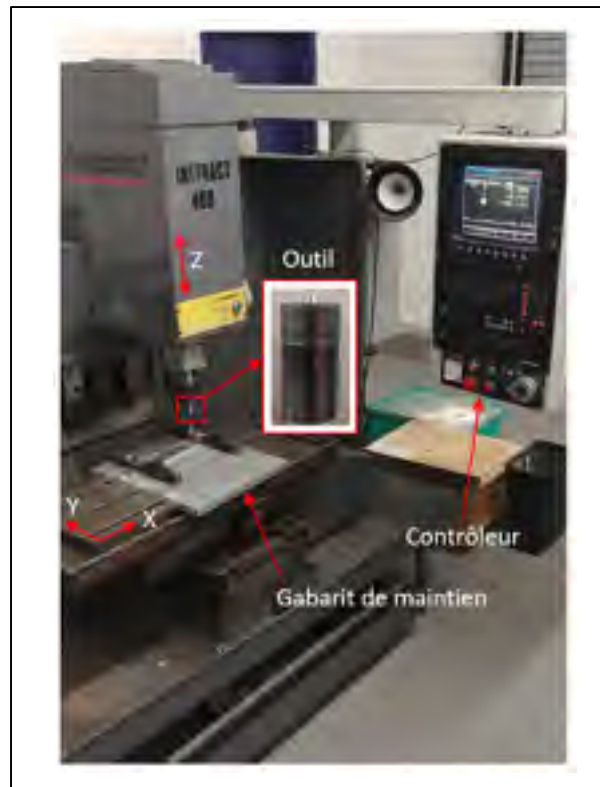
Figure 2-1. Machine et outil utilisés pour la production des soudures
