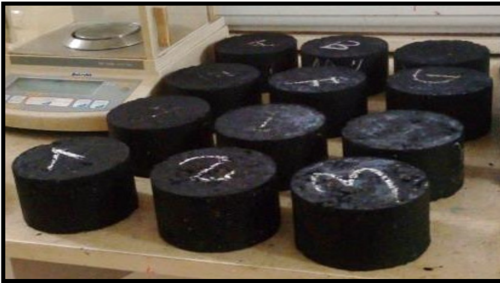
Figure 4-3: Exemples d'échantillons de béton bitumineux fabriqués et testés
