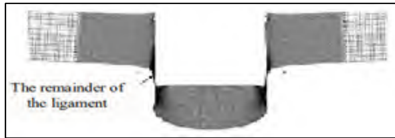
Figure 1-7 Critère en cisaillement maximal ( V_i = 244 m/s, contrainte limite 525 MPa)
