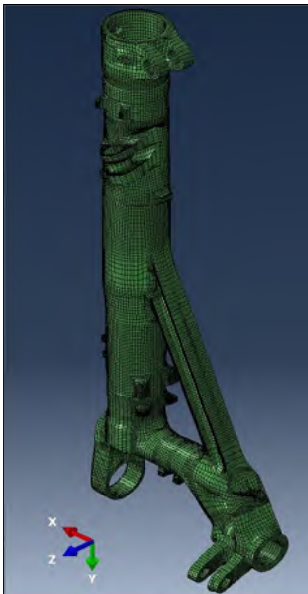
Figure 2.2 Modélisation d'un caisson de train d'atterrissage avant traitement thermique
