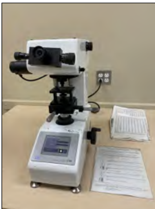
Figure 2.21 Machine FM-100 de mesure de microdureté
