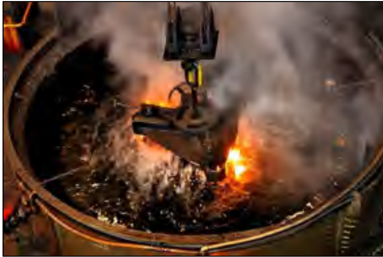
Figure 1.7 Trempe d'une pièce industrielle (Neil Forman Photography, 2019)
