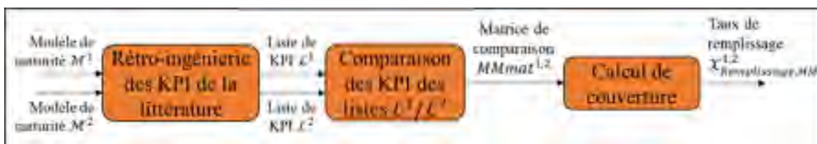
Figure 3.1 Méthode de comparaison manuelle pour deux modèles de maturité \mathcal{M}^1 et \mathcal{M}^2
