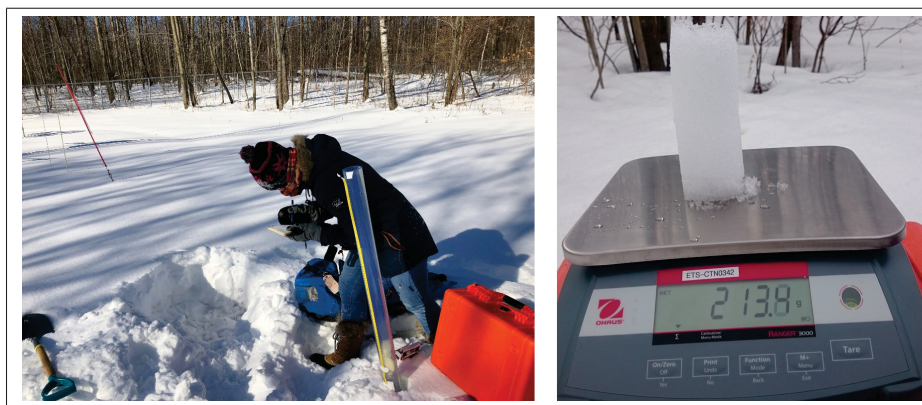
Figure 3.1 Manipulations lors d'une procédure d'échantillonnage du manteau neigeux
