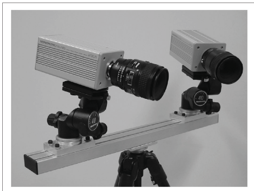
Figure 1.13 Dispositif utilisé par Orteu (2009) pour réaliser une corrélation d'image en 3 dimensions
