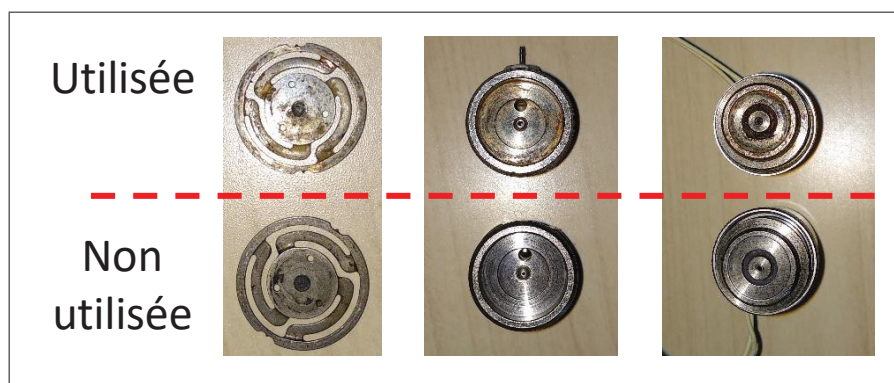
Figure 3.4 Comparaison entre une électrovalve usagée et neuve
