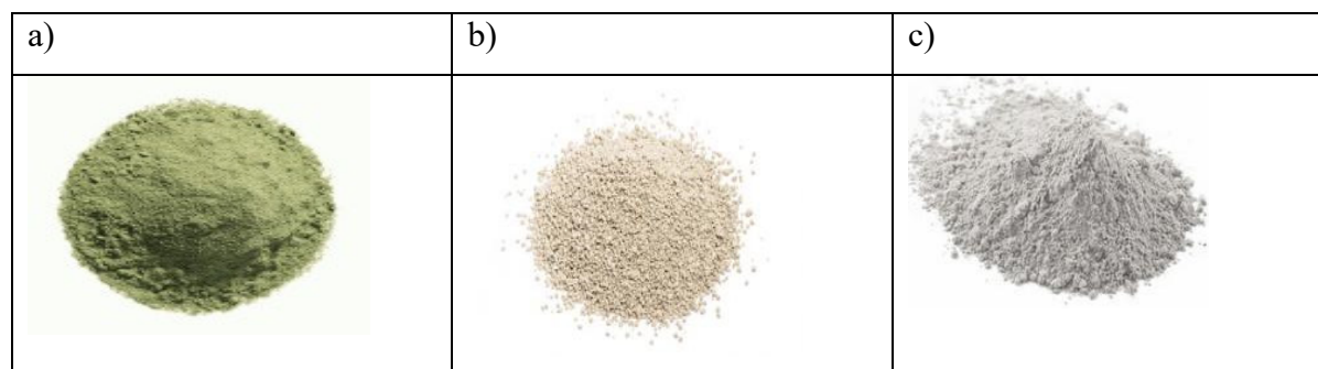
Figure 2.6 Types d'argiles utilisées a) illite + montmorillonite ; b) kaolin; c) bentonite
