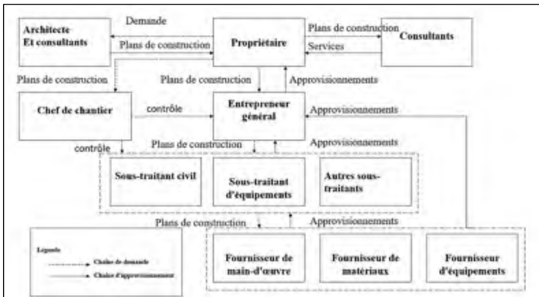
Figure 2.3 Collaborations dans la chaîne d'approvisionnement de la construction Adaptée de Hu (2008)
