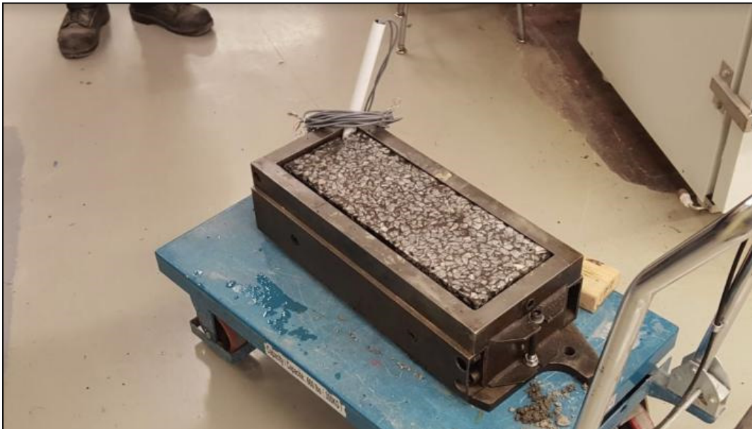
Figure 5.21 Le dépôt de la surface (enrobé bitumineux) sur le capteur
