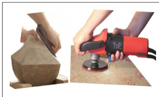
Figure 1-1: Polissage manuel du granit Tiré de www.pierres-info.fr
