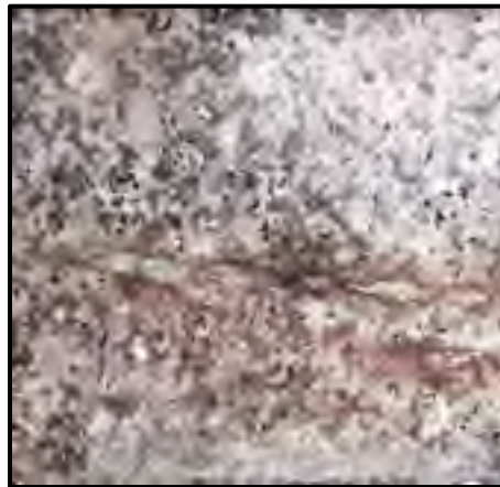
Figure : Brulure observée à la surface du granit blanc
