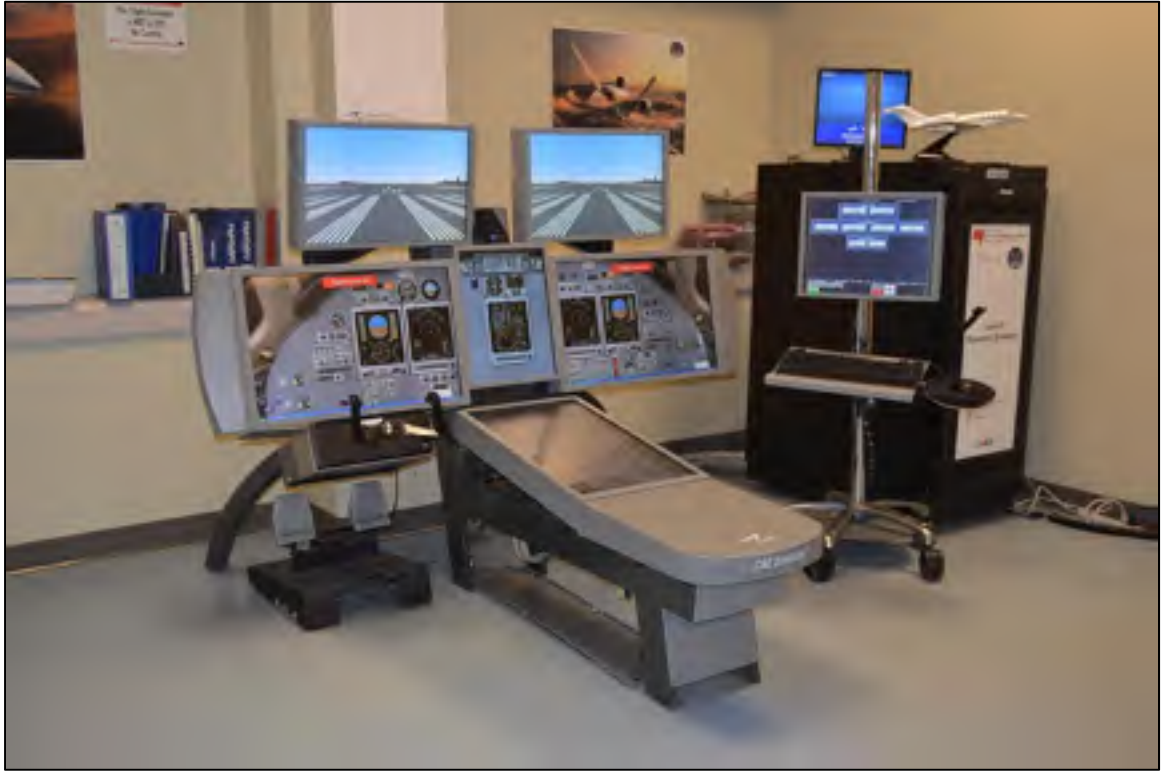
Figure 1.4 Le simulateur de recherche niveau D du Cessna Citation X du LARCASE
