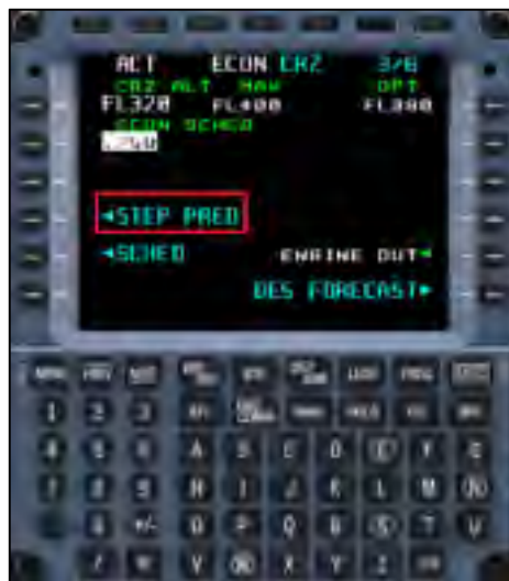
Figure 3.6 La fonction "STEP PRED" sur la page 3 "ECON CRZ" du menu "VNAV"
