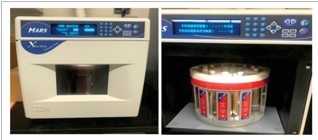
Figure 3.3 Micro-ondes utilisé pour la préparation des échantillons
