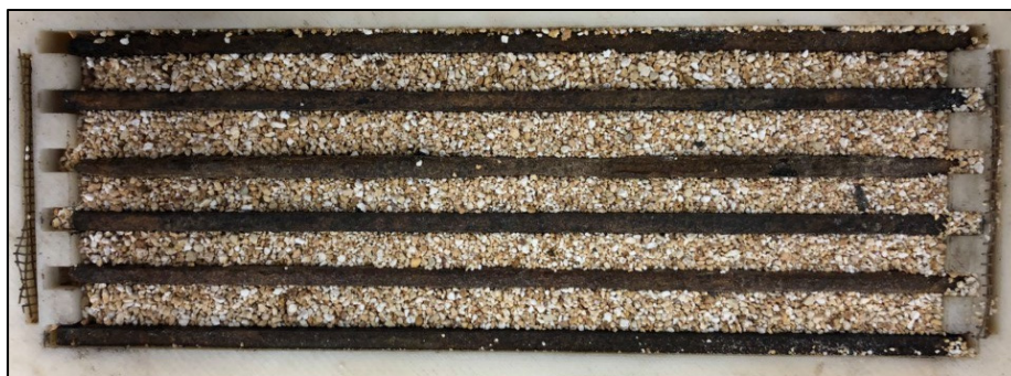
Figure 2.4 : Compartiment central du réacteur électrochimique
