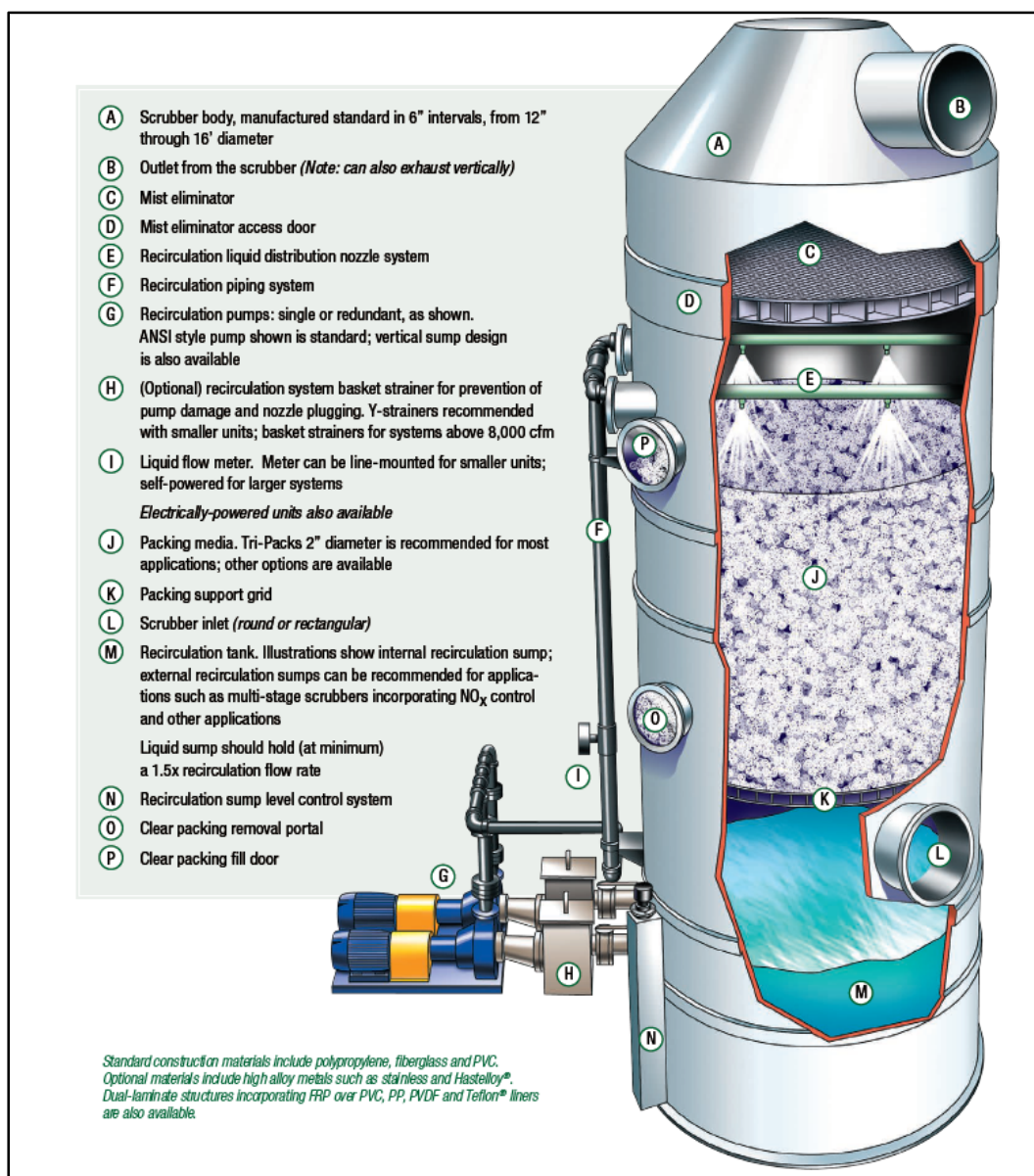
Figure-A II-1 Schéma détaillé d'un épurateur vertical
