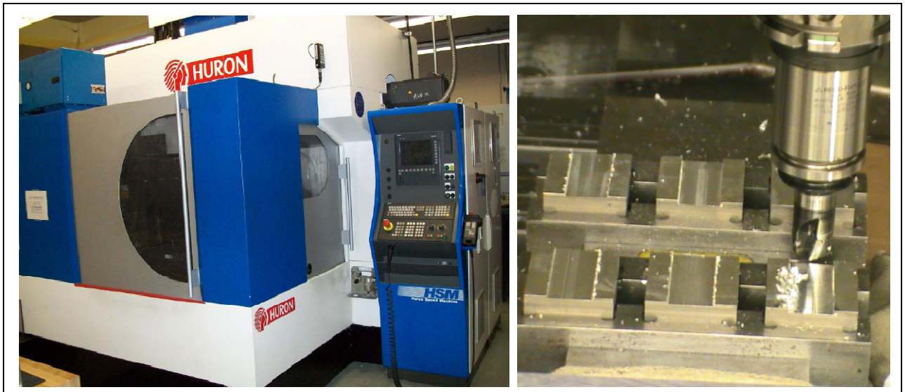
Figure 2.1 Usinage sur centre d'usinage 3 axes HURON K2X10.
