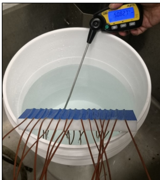
Figure 2.17 Calibration des thermocouples à une température chaude de 50,8°C
