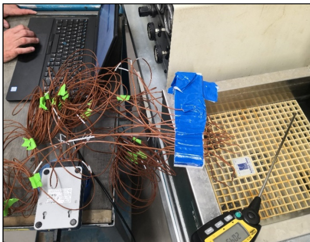
Figure 2.16 Calibration des thermocouples à une température pièce de 20,4°C
