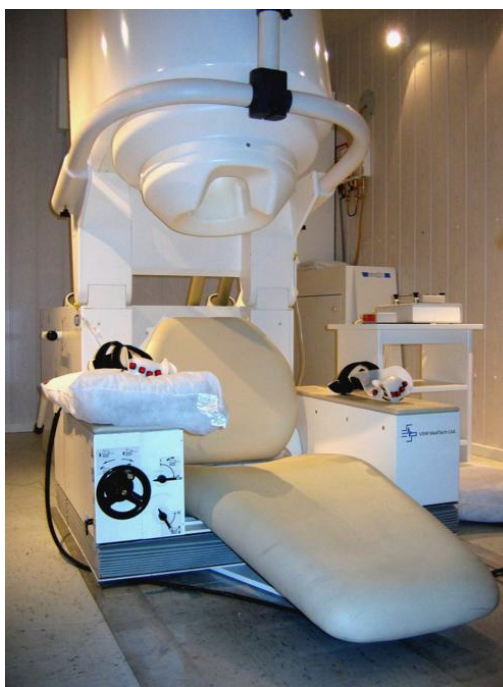
Figure 1.7 Photo d'un capteur MEG Tirée de https://www.radiologyinfo.org
