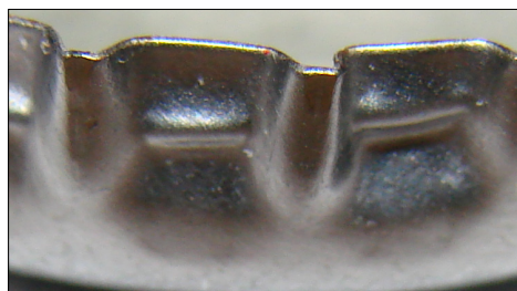
Figure 7.14 Capsule sertie automatiquement.
