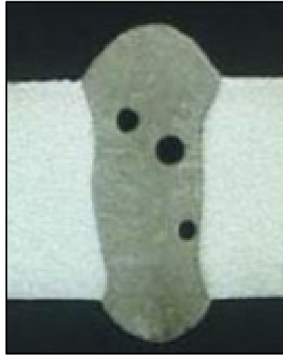
Figure 1.4 Porosités dues à la dissolution puis au rejet d'hydrogène lors du soudage dans un joint de soudure réalisé en mode keyhole Tiré de (Xiao & Zhang, 2013)
