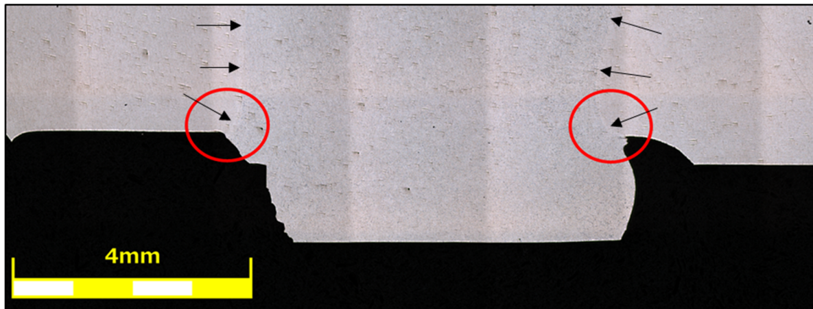
Figure 4.14 Aperçu de la partie basse d'une coupe de la plaque 0677 où la tôle de droite comprend un reste des protubérances de mise en position qui a laissé une légère surépaisseur par rapport au côté gauche et où les flèches indiquent la ZAT
