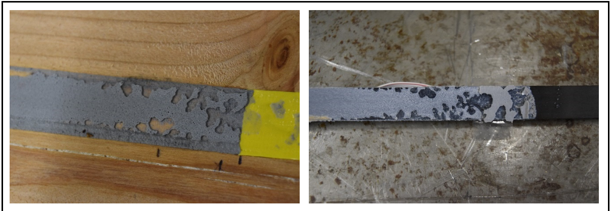
Figure 6.17 Mauvaise adhérence du spécimen F-AL500-1L17-01
