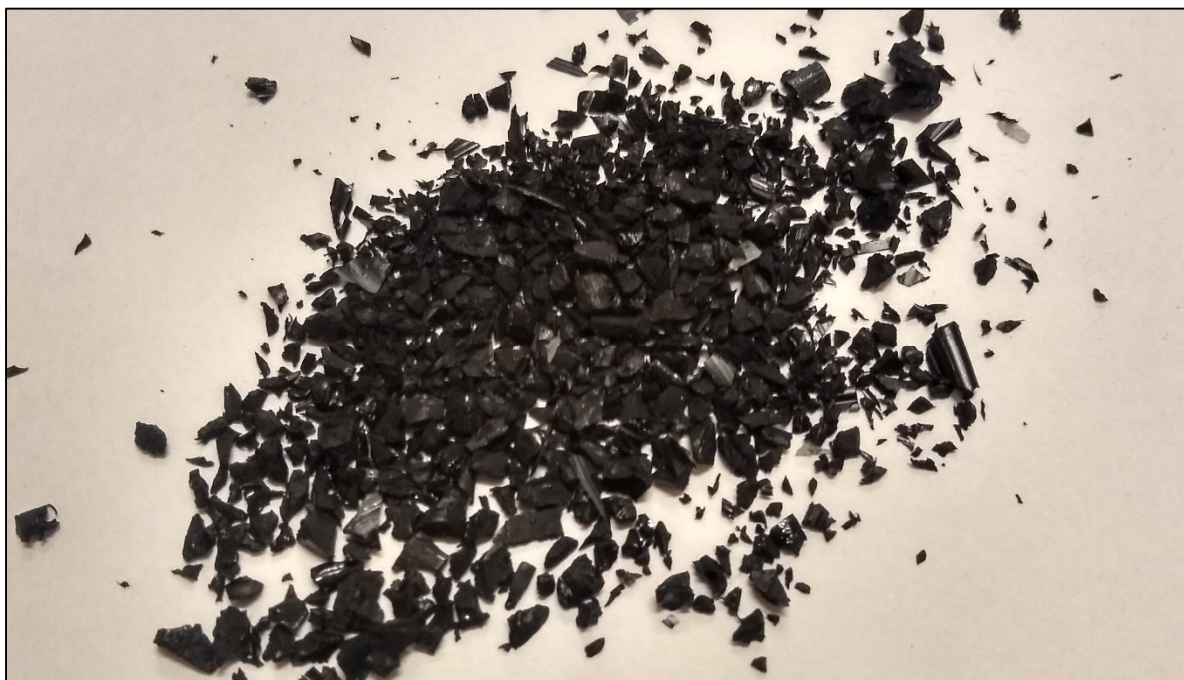
Figure 2.2 Mélange maître déchiqueté de PEI avec 15 % de NC
