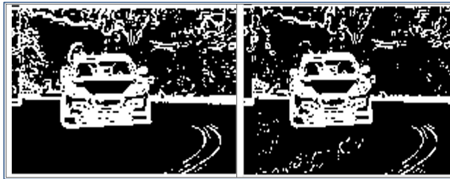
Figure-A II-3 Résultat d'injection de pannes sur Video_in=23 S@1 (droite de la figure) et résultat de la simulation de référence sans panne (à gauche de la figure)
