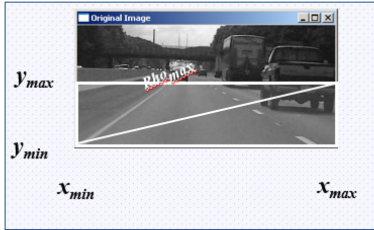
Figure 3.13 Représentation des coordonnées max et min
