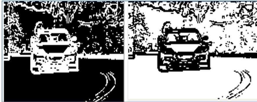
Figure 3.23 Résultats d'injection de pannes sur Background S@0 (figure droite) et résultat de la simulation de référence sans panne (figure gauche)
