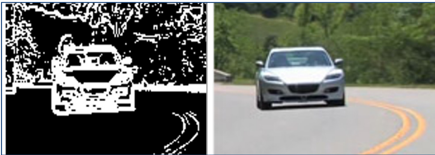
Figure 3.21 Résultats d’injection de pannes sur Sobel_Enable S@0 (figure droite) et résultat de la simulation de référence sans panne (figure gauche)
