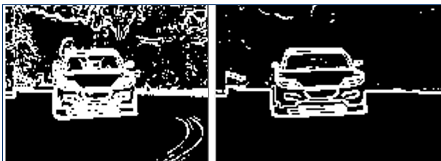
Figure 3.19 Résultats d'injection de pannes sur Threshold 8 S@1 (figure droite) et résultat de la simulation de référence sans panne (figure gauche)
