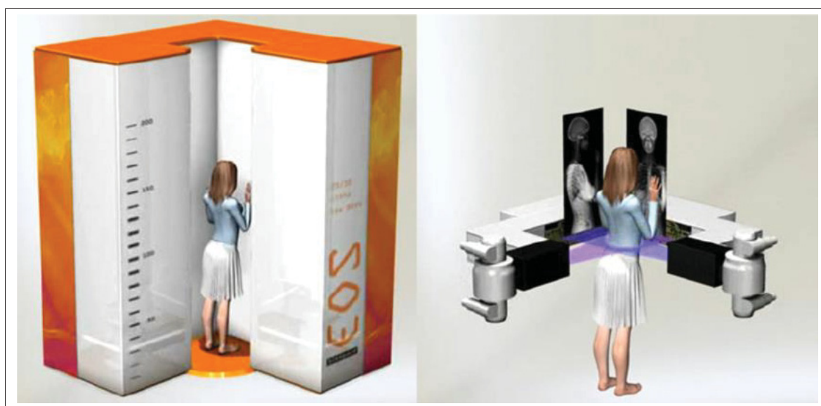
Figure 1.8 Processus d'acquisition de radiographies EOS Tirée de Illés & Somoskeöy (2012)
