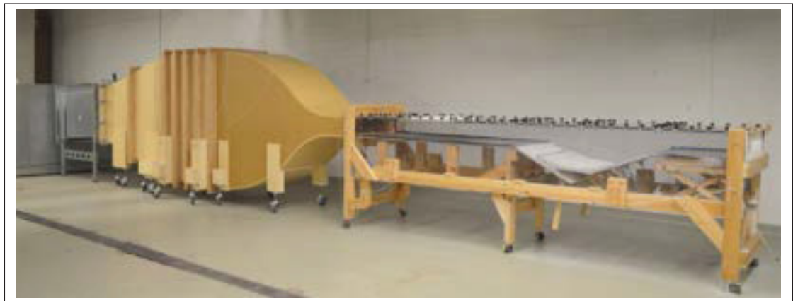
FIGURE 2.1 Soufflerie à couche limite du laboratoire TFT
