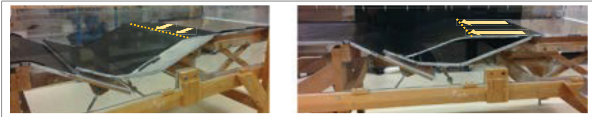
FIGURE 2.3 Insertion des blocs dans la section d'essais à gauche celui pour créer le bulbe moyen et à droite celui pour créer le petit bulbe avec les flèches jaunes qui matérialisent la réduction de la taille du berceau
