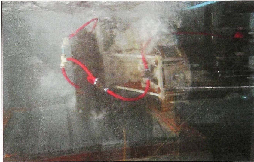
Figure 6.9 Essai de meulage sous l'eau avec injecteur d'air.
