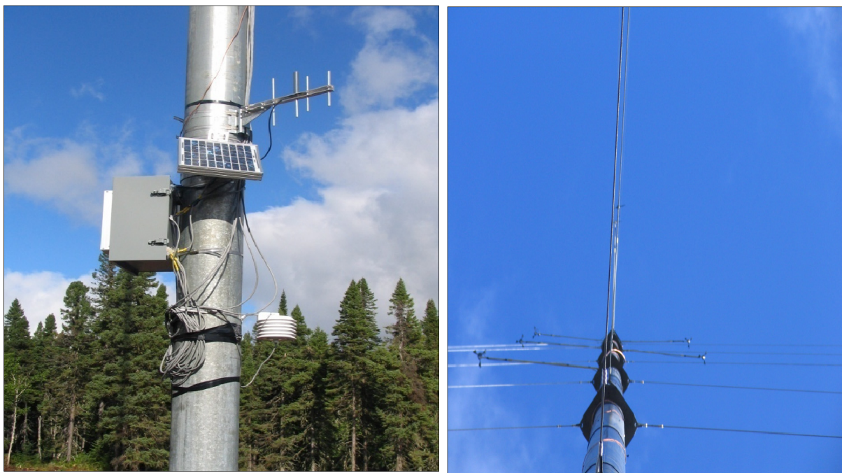
Figure 2.1 Mâts météorologique tubulaire. Source : Hélimax Énergie.
