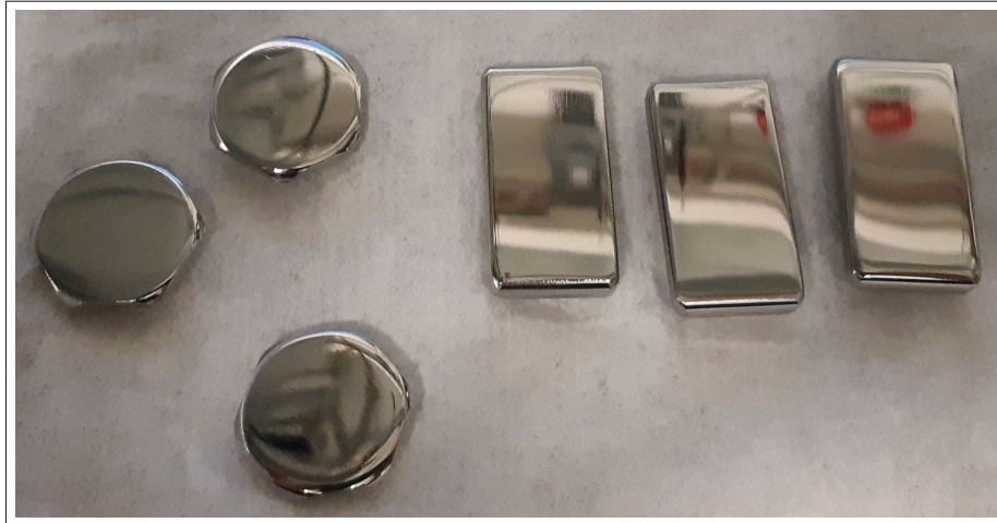
Figure 4.4 Photographie des pastilles utilisées pour les essais, telles que reçues
