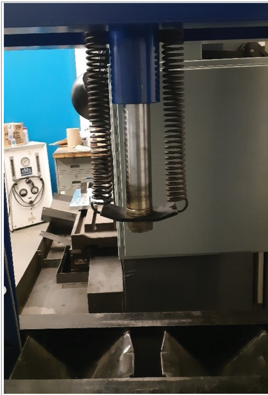
Figure 2.14 Photographie du piston hydraulique installé sur la presse servant de châssis au banc d'essai
