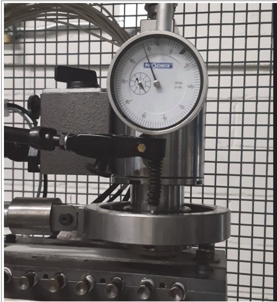
Figure 3.26 Photo du montage du comparateur pour la calibration du système de mesure de l'effort normal
