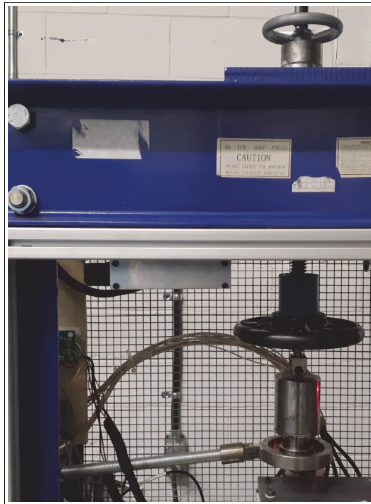
Figure 2.18 Photographie du système de pression installé sur le banc d'essai
