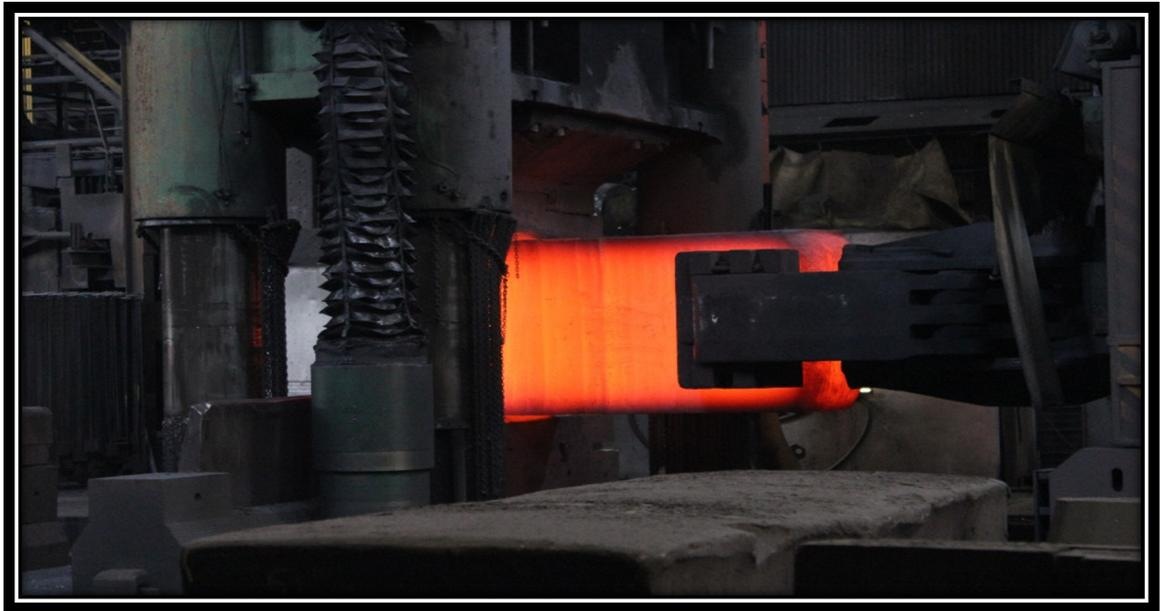
Figure 1.2 Lingot en forgeage sous la presse hydraulique aux forges de SOREL Canada
