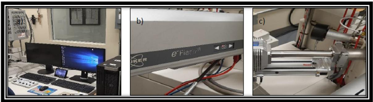
Figure 2.9 a) microscope électronique à balayage b) détecteur EBSD c) détecteur EDX
