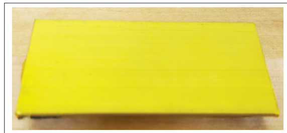
Figure 2.4 Plaque d'aluminium isolée avec un film en polyamide
