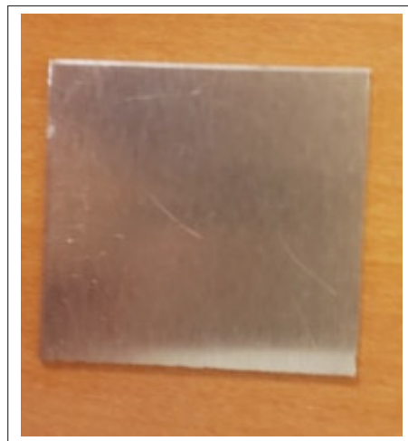
Figure 2.6 Plaque d'aluminium isolé avec le dioxyde de silicium
