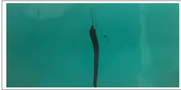
Figure 2.11 Décollage de la peinture pour la feuille conductrice - Velostat
