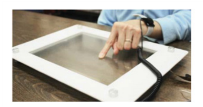
Figure 1.4 Première utilisation d'un écran tactile commercial pour procurer des sensations électro-vibratoires Tirée de Bau et al. (2010)
