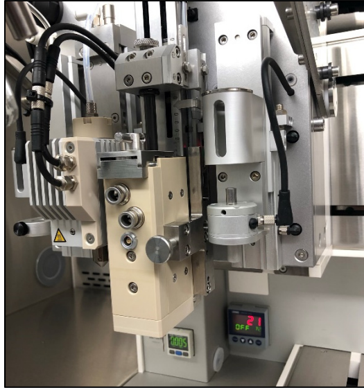
Figure 2.6 Bio-imprimante 3DDiscovery (RegenHu) équipé de 4 systèmes d'impression : extrusion pneumatique, extrusion par contrôle de débit, extrusion de polymère fondu et par jet d'encre
