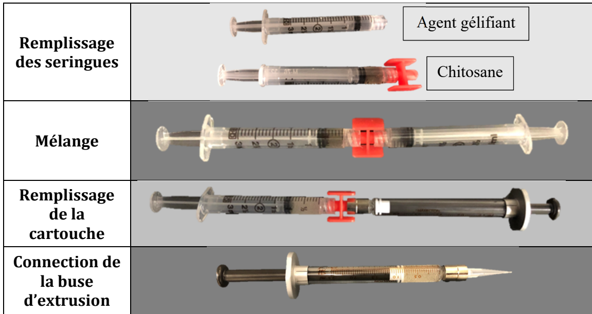
Figure 2.2 Méthodes de préparation des gels à base de chitosane pour la bio-impression
