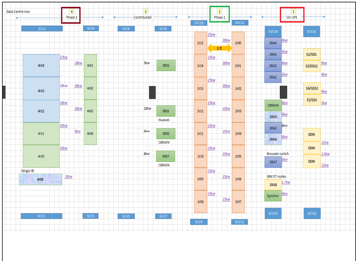
Figure 4.1 L'architecture de centre de données CLUMEQ
