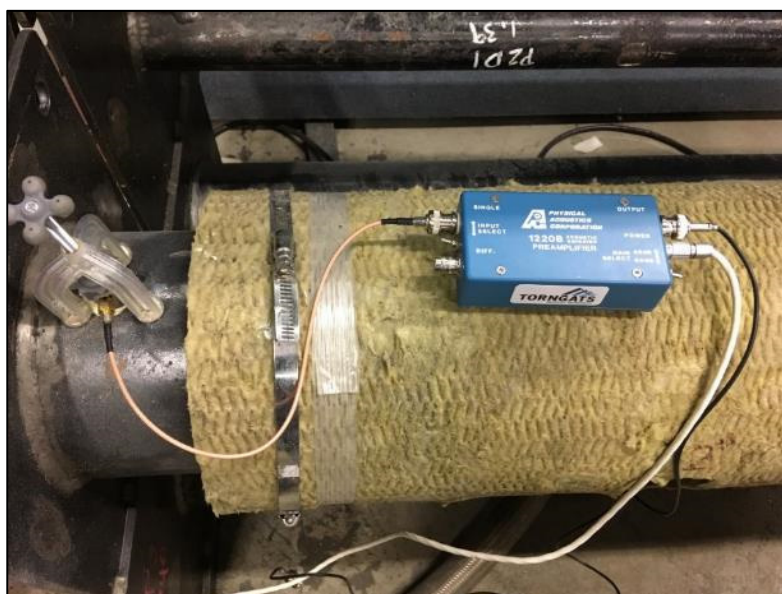
Figure 2.1 Capteur d'ÉA, support et préamplificateur installés sur le banc d'essai
