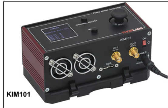
Figure 2.4 Contrôleur KIM101 K-Cube™ de Thorlabs™ Tirée de Thorlabs (2021)
