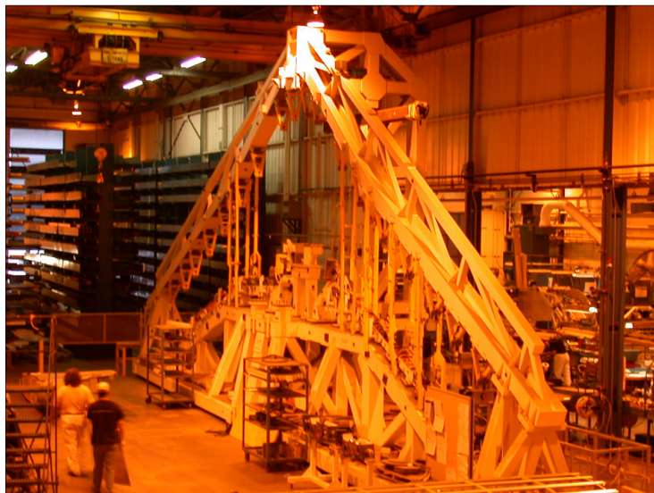
Figure 1.1 Exemple d'un gabarit d'assemblage aéronautique, avec la permission de Bombardier Aéronautique
