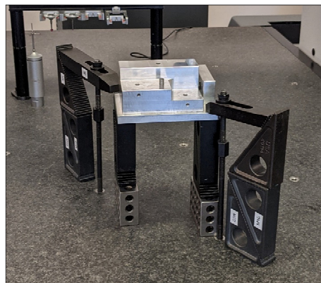
Figure 3.13 Montage expérimental pour l'étude de répétabilité
