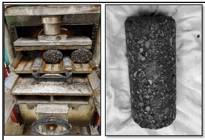
Figure 3.9 : Resurfaceuse et éprouvettes obtenues
