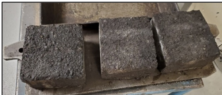
Figure 3.7 : Échantillon scié pour fin de carottage
